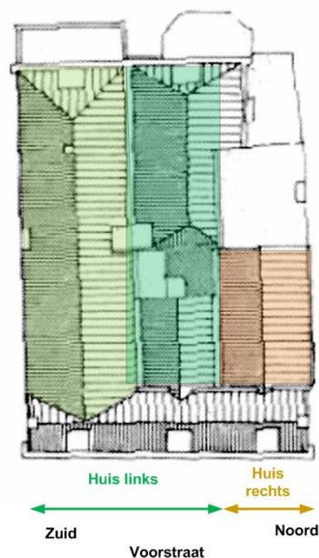
Afb. 6: dakplan met aan de onderkant de kap links op de foto 5, parallel aan de Voorstraat en daarboven de drie kappen haaks op de straat. Bron: gemeente Brielle.
