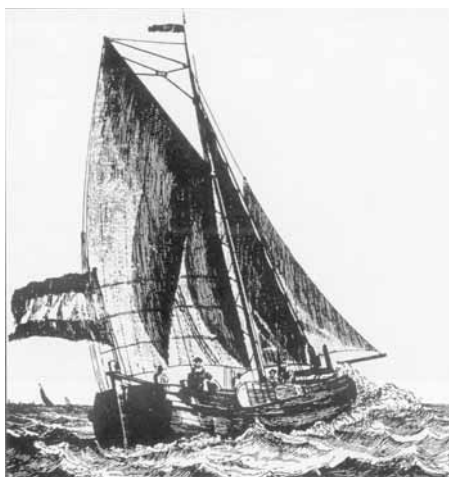
Zwartewaalse gaffelaar zoals gebruikt voor de vangst op kabeljauw en schelvis, in de buurt van IJsland en bij de Doggersbank.
